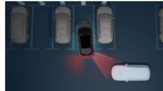
Rear Cross Traffic Alert and Braking (RCTA + RCTB) ระบบช่วยเตือนและระบบช่วยเบรกเมื่อมีรถผ่านในจุดอับสายตาทางทะน่กอยหลัง
